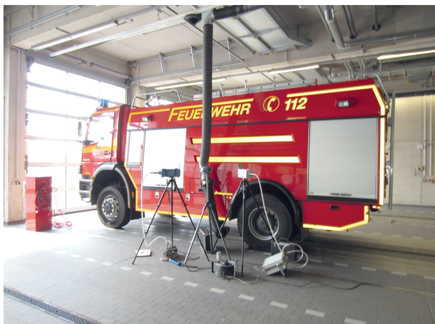
Messung der Abgase, hier bei aufgesteckter mitfahrender Absaugung an einem Tanklöschfahrzeug
